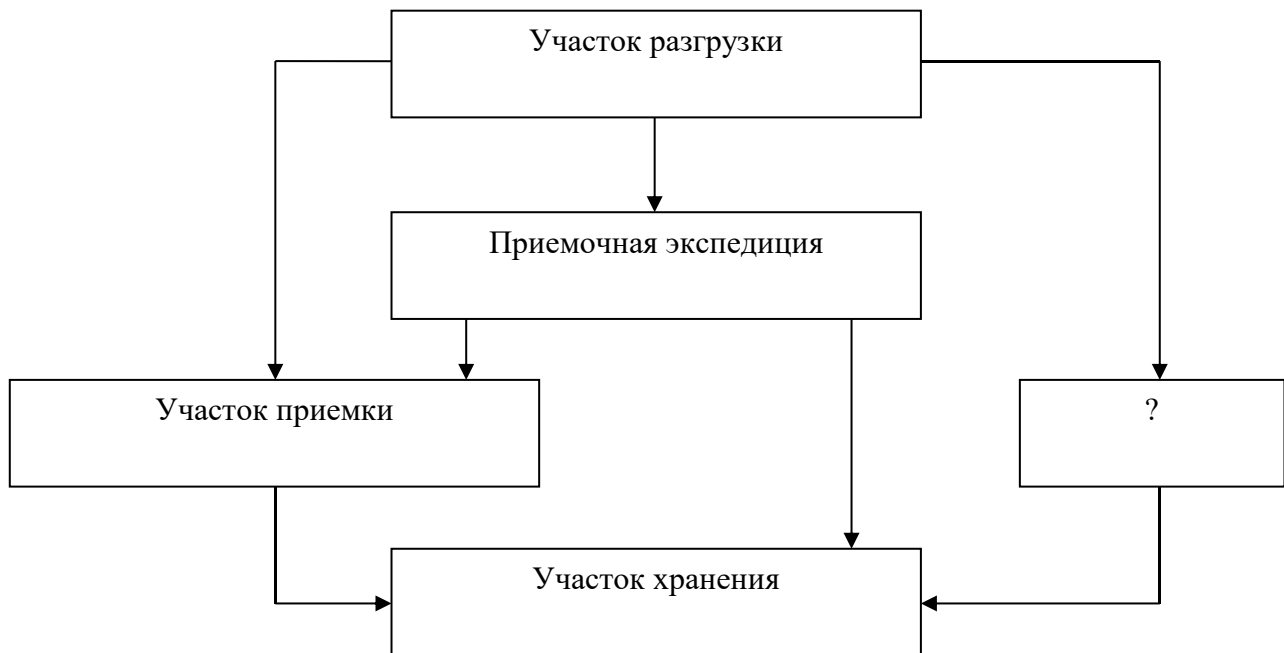
Рисунок 2.1 – Схема движения материального потока на складе
